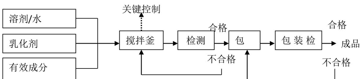
1、将水/溶剂、乳化剂计量后投入搅拌釜中搅拌至溶解均匀；
